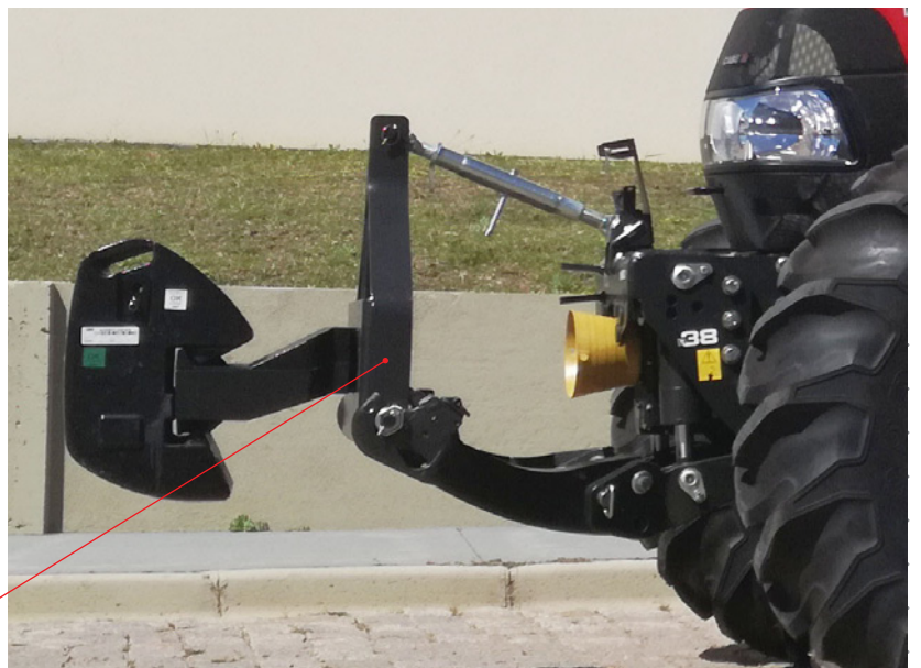
Suporte porta pesos Permite utilizar os pesos originais do trator
