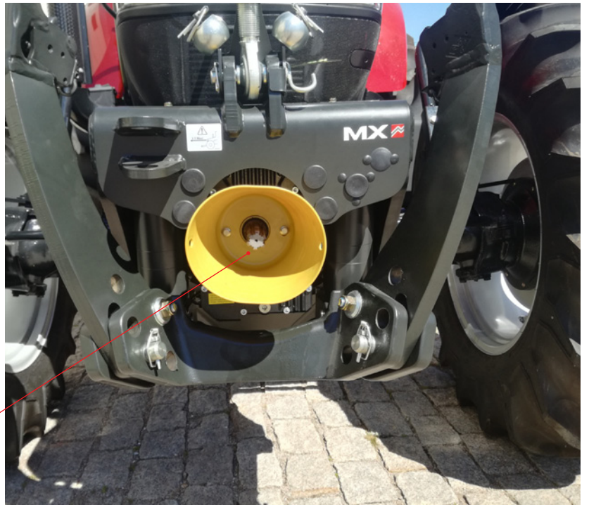
TDF com embreagem integrada, potência máx. 150 hp ou 200 hp (Opcional)
