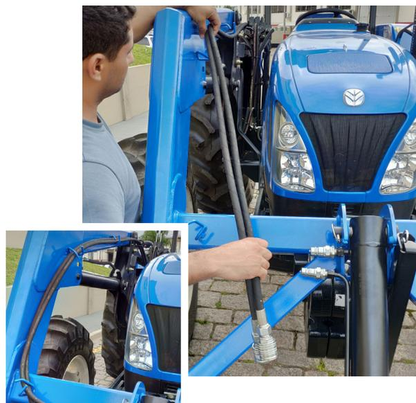
— Conecte as juntas do macaco de basculamento.
